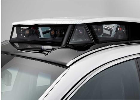
El auto de prueba Toyota Lexus LS 500h con todos los sensores en el techo.
